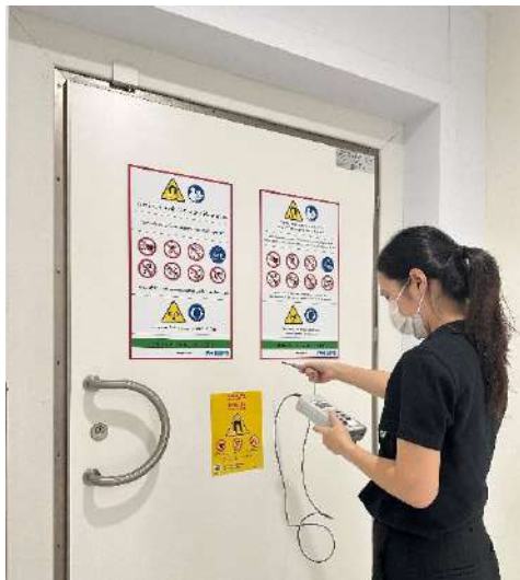
รูปที่ 18 เจ้าหน้าที่วัดความเข้มสนามแม่เหล็กรอบห้องเอ็มอาร์ไอใน Zone 3
