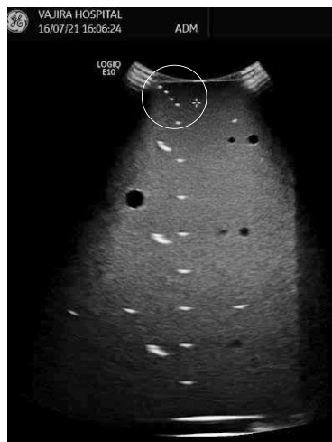
รูปที่ 8 การวัดระยะที่ไม่มีการเก็บข้อมูล (Ring down หรือ Dead zone)
