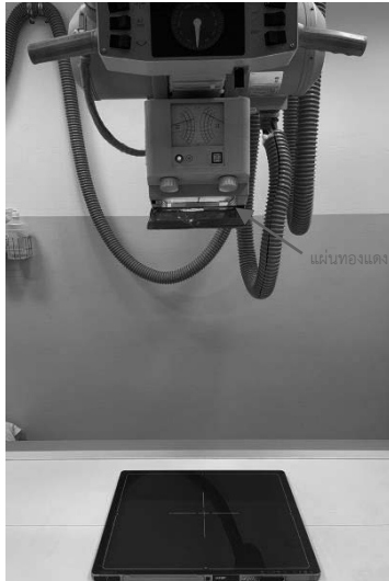
รูปที่ 1 การวางแผ่นรับภาพและการติดแผ่นทองแดงหน้าคอลลิเมเตอร์
