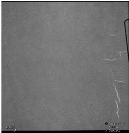
รูปที่ 3 ความชำรุดเสียหายของชุดกำบังตะกั่ว เมื่อตรวจสอบด้วยรังสีเอกซ์จากเครื่องส่องตรวจทางรังสี
