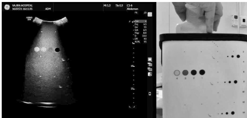
รูปที่ 7 การทดสอบการแสดงระดับสี (Gray Scale Display)
